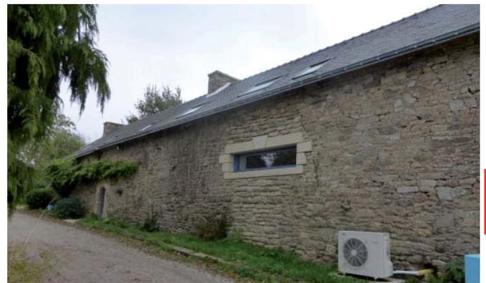
Eviter des création d'ouverture avec des proportions modernes, qui ne s'accorde pas avec le bâti d'origine. Travailler plutot avec des ouvertures verticales.
