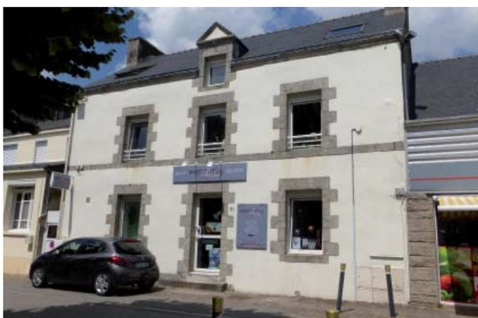
Les menuiseries étaient à l'origine des menuiseries en bois à petits carreaux (probablement 6 carreaux) Elles ont toutes disparu au profit de menuiseries en aluminium de couleur ou en PVC à un ou deux vantaux.
